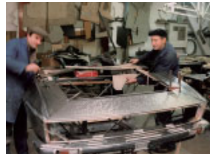
Das Team Zoggia und Pavarain bei der Fertigung von Reparaturblechen für eine komplette High-Speed-Front. Im Hintergrund hängen die unzähligen Schablonen und Muster für weitere Monteverdi-Carrosserieteile.
