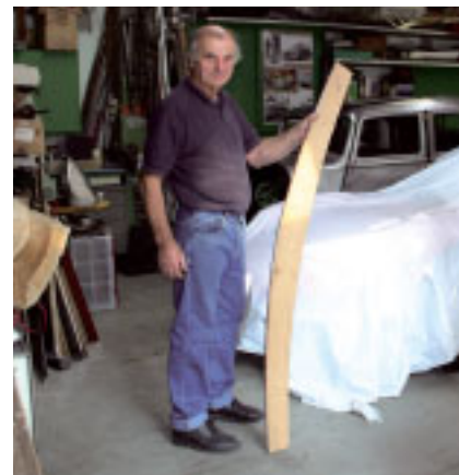
Gino heute: Sein Carrosserie-Atelier bietet wahre Schätze. Neben zahlreichen fertigen Blechteilen findet man auch jede Menge Schablonen, Lehren und Muster. Hier hält der Maestro gerade die Holz-Passform für eine Monteverdi-Stossstange in der Hand.
