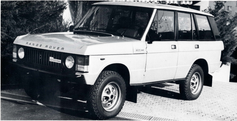
Range Rover/MONTEVERDI-Design mit 5 Türen auf Original-Radstand. Diese Version wurde von British Leyland unter verschiedenen Prototypen ausgewählt und in Serienmontage hergestellt
